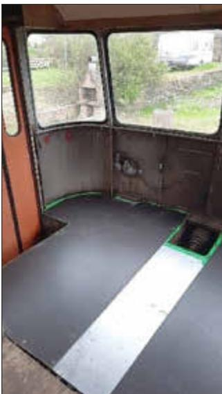
Auch beim Ausbau des Uerdinger Schienenbusses geht's nun endlich weiter, nachdem vor dem Winter die vorbereitenden Maßnahmen an der Karosserie nicht mehr ausgeführt werden konnten, erfolgt aktuell der Bodenaufbau.
